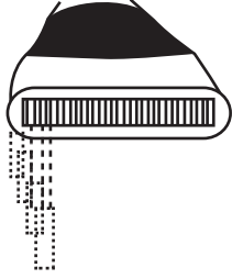
Resim 10. Ardışık uyarımlı lineer dizimli elektronik transdüser.
